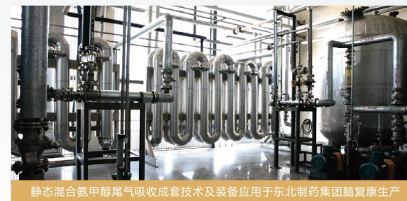
静态混合氨甲醇尾气吸收成套技术及装备应用于东北制药集团胞复康生产
